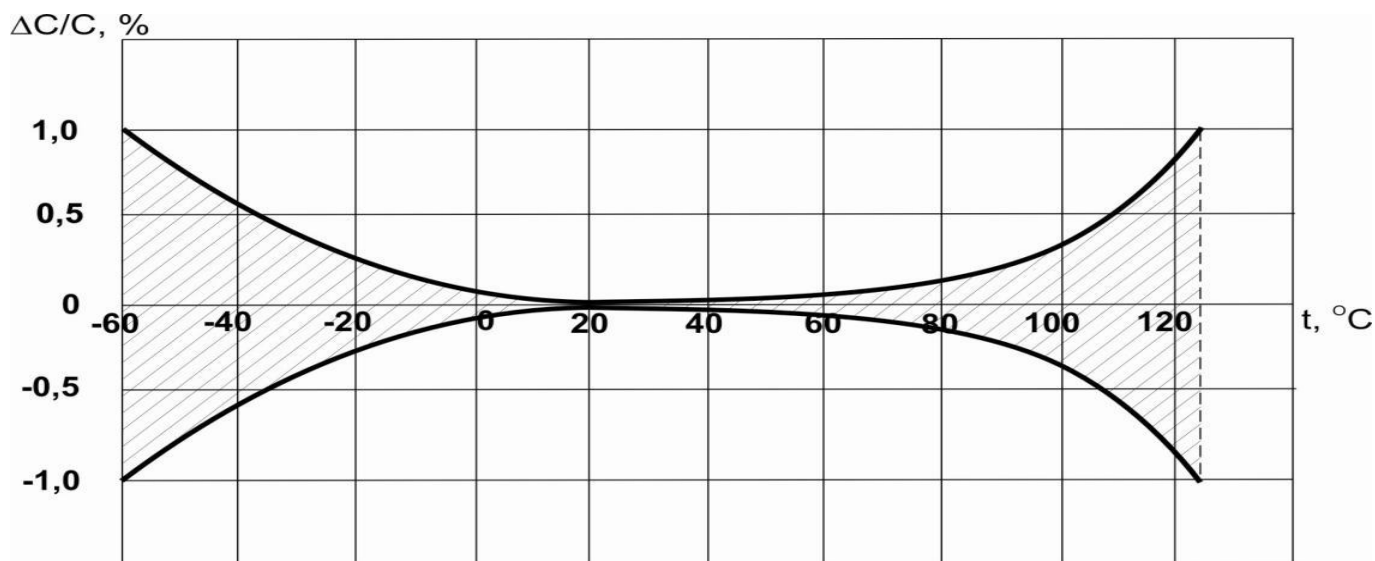
Рис.2 – Допустимая область относительного изменения емкости конденсаторов от температуры
