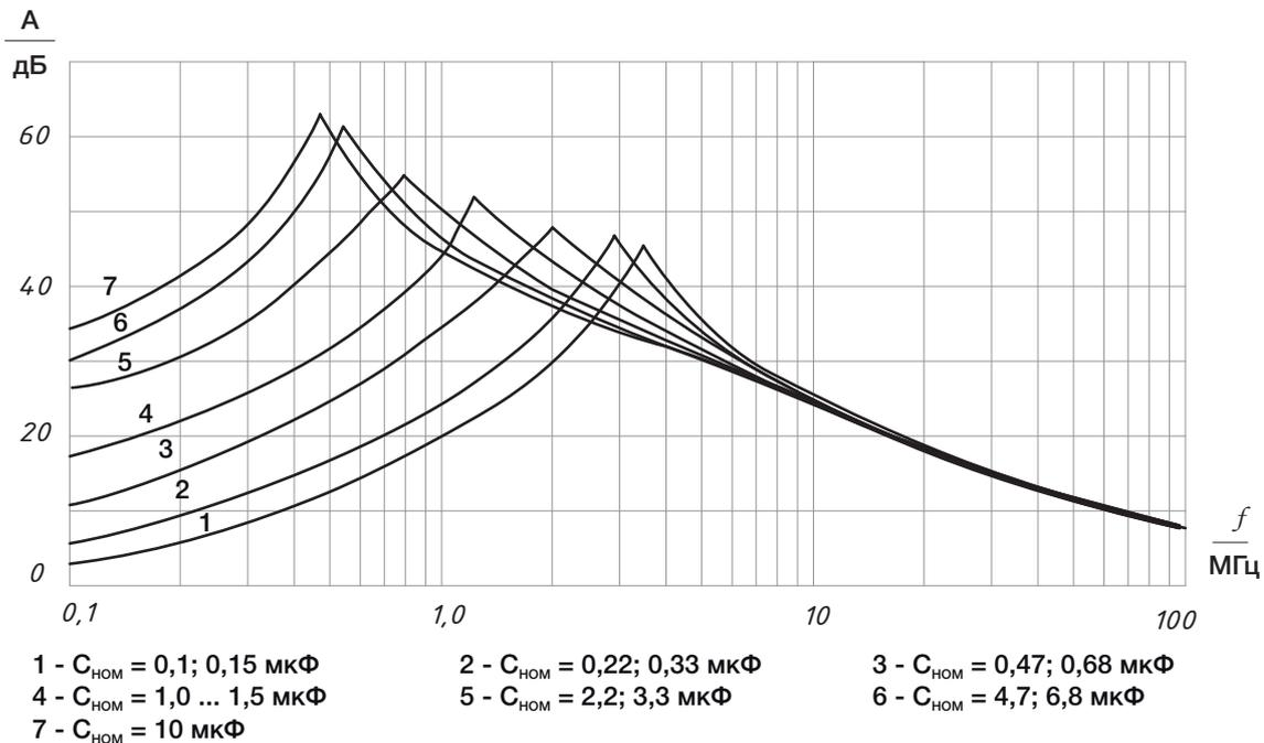
Зависимость вносимого затухания от частоты  $f$  для конденсаторов варианта «г»
