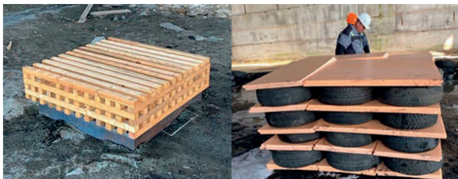
Рисунок 1 – Модельный очаг для групп помещений 1 и 2 (слева), 3 (справа)
