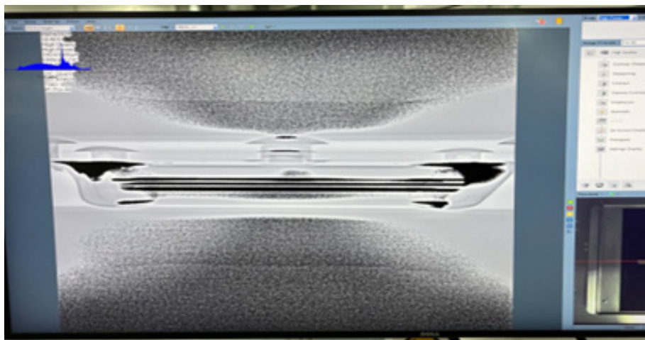
Рисунок 1 – Рентгеновская фотография межслойных проводников конденсаторной структуры из порошка ООО «Фокон»-ООО «ЭЛМА-ПАСТЫ»
